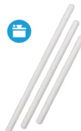
Agitador de plástico con puntas redondas en forma de gota. Fabricado en polipropileno y es autoclavable.
