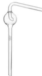
Alargadera tipo Kjeldahl de vidrio borosilicato de forma esférica o cilíndrica. Se utiliza en los equipos de digestión para determinación de nitrógeno y contenido de proteínas de los alimentos.
