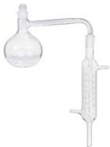
Aparato en vidrio de borosilicato, utilizado en la destilación de uso general y la destilación del fenol. Consta de matraz con junta 19/38, tapón y condensador Graham de 200 mm.
