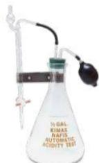
Aparato para determinar la acidez en leche cruda, queso y otros derivados lácteos. Da lecturas directamente en porcentaje de acidez de 0 a 1%. Fabricado en vidrio de borosilicato, consta de bureta, tubo de llenado, vaso de precipitado de 100 mL, succionador de hule, botella de depósito, agitador de vidrio, pinza y pipeta de 9 mL.
