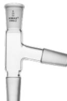
Tubo conector de tres vías en vidrio borosilicato con ángulo de 75°. Ideal para utilizarse en destilación atmosférica o al vacío. Junta superior tipo hembra, juntas inferior y lateral tipo macho.
