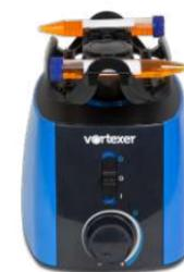
Agitador tipo Vortex modelo VORTEXER con tres velocidades fijas y cabezal multipropósito. El cabezal no necesita ser cambiado y puede mezclar hasta 8 tipos diferentes de tubos y placas (placas de pozos, y tubos de 2x50mL, 2x15mL, 2x5mL, 4x1.5/2.0mL, 6x0.5mL y 24x0.2mL). Cuerpo elaborado de ABS resistente a químicos.
