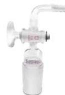
Tubo conector en vidrio de borosilicato con ángulo a 90°, llave y junta tipo macho.
