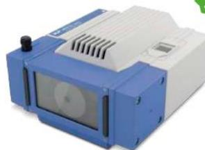
Bomba de vacío modelo MVP 10 con sistema de diafragma, para aplicaciones en seco; no requiere aceite. Ideal para rotaevaporadores, filtración y secado al vacío, y aplicaciones al vacío con agentes químicos corrosivos. Diseño compacto, mantenimiento sencillo y larga vida útil. Resistente a productos químicos; todas las partes que están en contacto con los gases y vapores son de PTFE.
